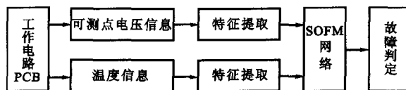
图 2 故障诊断原理框图
